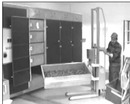
Fot. 1. Szafa łuszcarska; 1 – pulpit sterowniczy, 2 – otwarte drzwi jednej komory szafy, 3 – komora szafy z szufladami, 4 – szuflada z szyszkami, 5 – wózek widłowy do manipulacji (fot. J. Walczyk)
