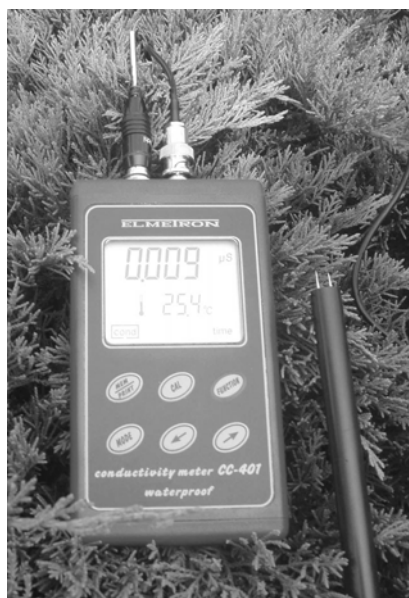
Konduktometr z elektrodą do pomiaru admitancji sadzonek (fot. W. Wesoly)
