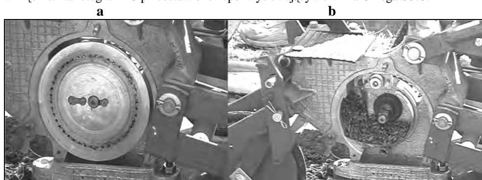
Fot. 13. Zespół wysiewający siewnika pneumatycznego zastosowanego w szklarni; a – tarcza wysiewająca po demontażu pokrywy podciśnienia, b – komora nasienna po demontażu tarczy wysiewającej (fot. J. Walczyk)
