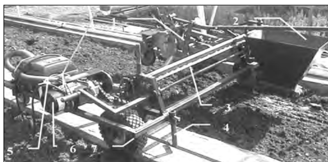
Fot. 14. Agregat do wysiewu nasion w namiocie foliowym; 1 – sekcja siewnika, 2 – piaskarka, 3 – rama nośnika, 4 – rolka prowadząca, 5 – źródło podciśnienia, 6 – elektryczny silnik napędowy, 7 – koło napędowe (fot. J. Walczyk)
