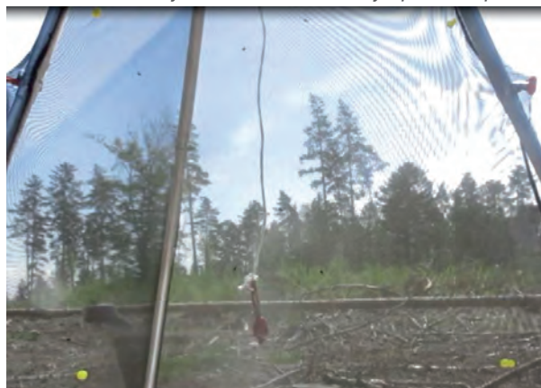
Fot 1. Obraz z kamery na Trinet® P z zaznaczonym pinezkami polem obserwacji 40x40 cm
