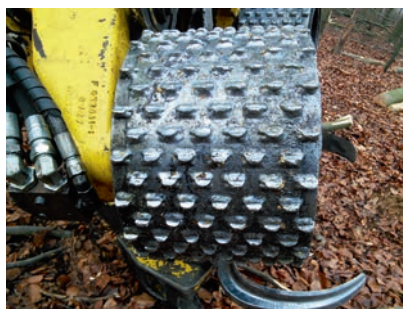
Głębokość uszkodzeń zależy od zastosowanych walców podających. Są również głowice korujące – w tym przypadku zdjęcie kory jest całkowicie zamierzone
