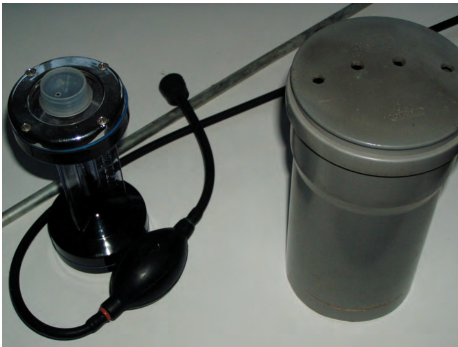
Ryc. 49. Mierniki tlenu w pryzmie kompostowej. Z prawej strony miernik „domowej” produkcji
