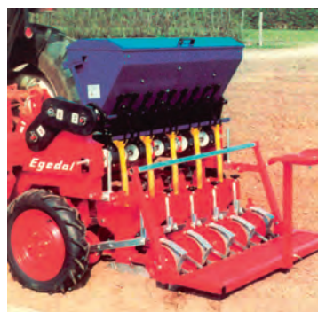
Ryc. 61. Siewnik nasion ciężkich z nadstawką do nasion lekkich
