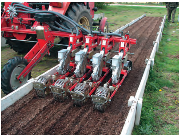
Ryc. 91. Siew punktowy w korytach z modyfikowanym siewnikiem do siewu połowego
