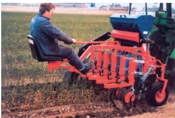
Ryc. 67. Rozsiewacz nawozów granulowanych, nabudowany na kultywatorze
