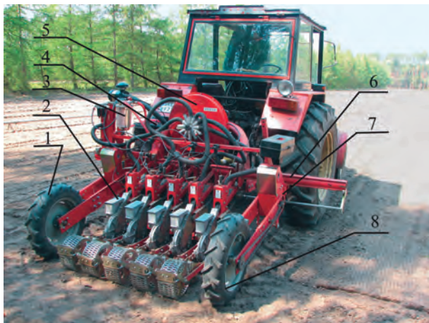
Ryc. 89. Siewnik punktowy do siewu w szkółce otwartej: 1 - koło podporowe ramy siewnika, 2 - sekcja wysiewająca, 3 - zbiornik do podciśnieniowego wysysania pozostałości nasion z sekcji, 4 - kompresor nadciśnienia, 5 - dmuchawa podciśnienia, 6 - rama główna siewnika, 7 - skrzynia przekładniowa układu napędowego sekcji siewnika, 8 - koło podporowo-napędowe ramy siewnika
