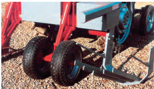
Ryc. 78. Wyorywacz asymetryczny z nożem aktywnym (drgającym)
