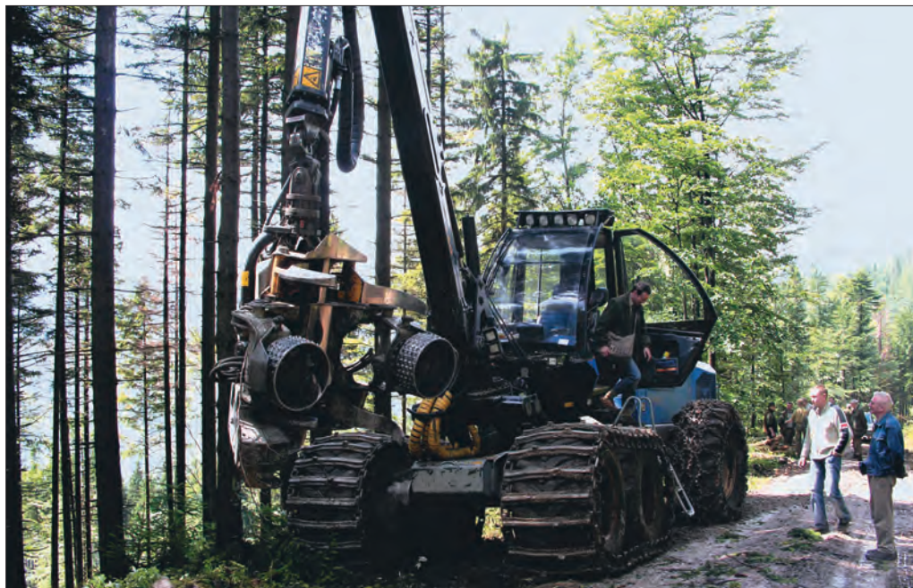
Fot. 31. Procesor do ścinki i zrywki drzew zasiedlonych w Nadleśnictwie Węgierska Górka (W.G.)
