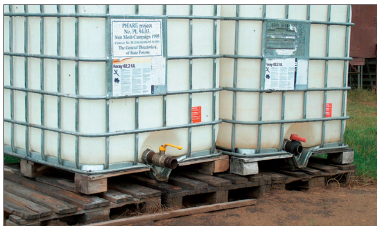
Ryc. 45. Zbiorniki o pojemności 1000 l do sporządzania cieczy użytkowej (fot. S. Majewski)
