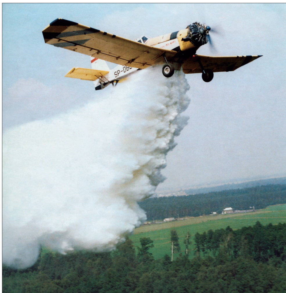
Ryc. 14b. Wersja gaśnicza samolotu M-18 Dromader (fot. Aerogryf)
