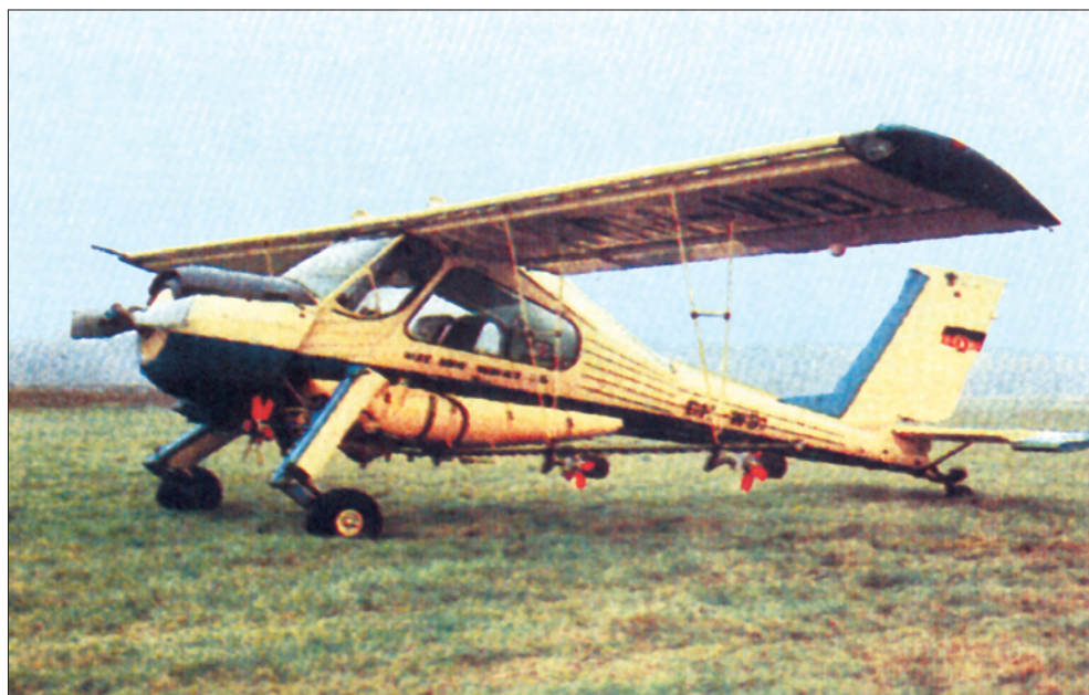
Ryc. 8. Samolot wielozadaniowy PZL-104 Wilga w wersji rolniczej (fot. PZL Warszawa-Okęcie)
