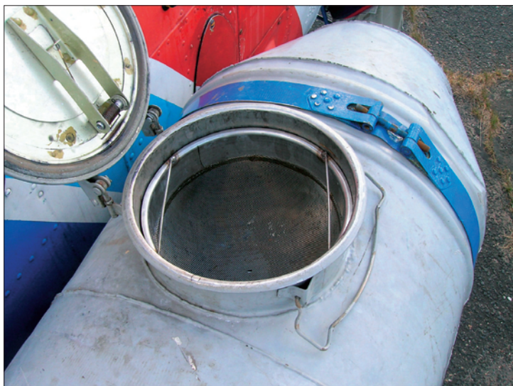
Ryc. 48a i 48b. Typy zbiorników stosowane w śmigłowcach Mi-2R (fot. S. Majewski)
