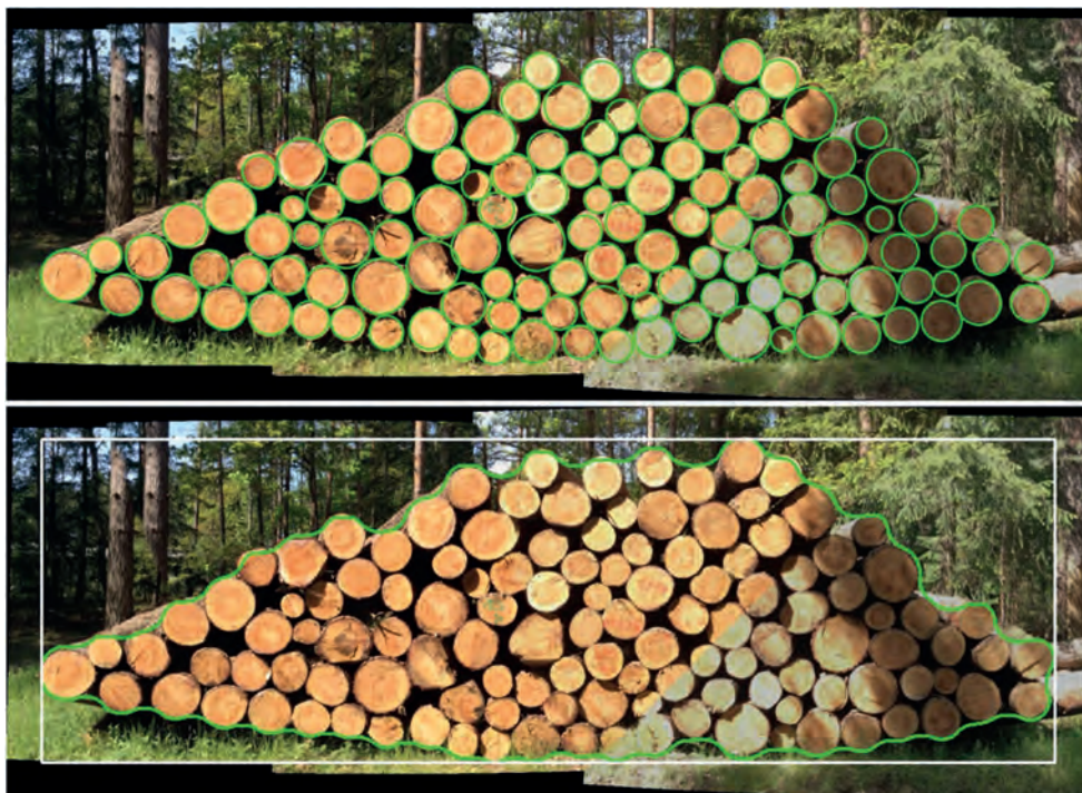
Fot. 4. Fotograficzny pomiar drewna za pomocą smartfonu
