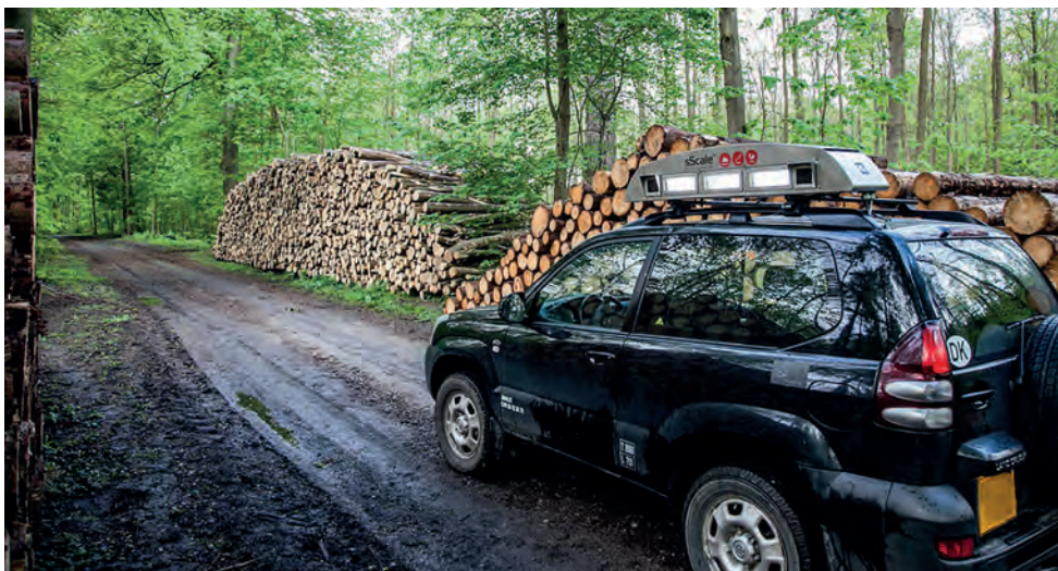
Fot. 5. Fotograficzny pomiar drewna za pomocą stereoskopowych kamer
