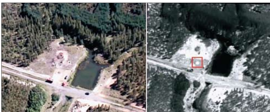
Lokalizacja źródła ognia – zdjęcia wykonane przez samolot bezzałogowy FlyEye podczas pokazu na terenie Nadleśnictwa Rudziniec 28.08.2012 r. (z lewej w świetle widzialnym, z prawej w termowizji)
