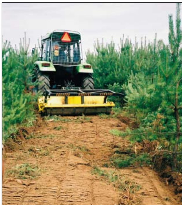
Wykonywanie pasa i drogi w młodniku
