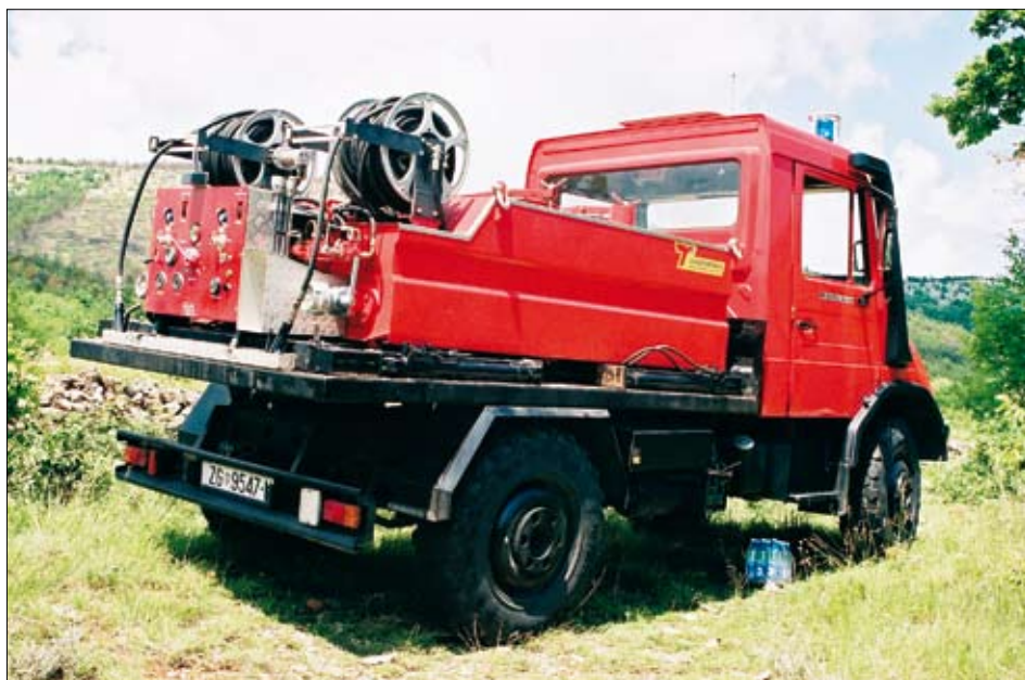
Specjalistyczny samochód do gaszenia pożarów lasu w bardzo trudnych warunkach terenowych
