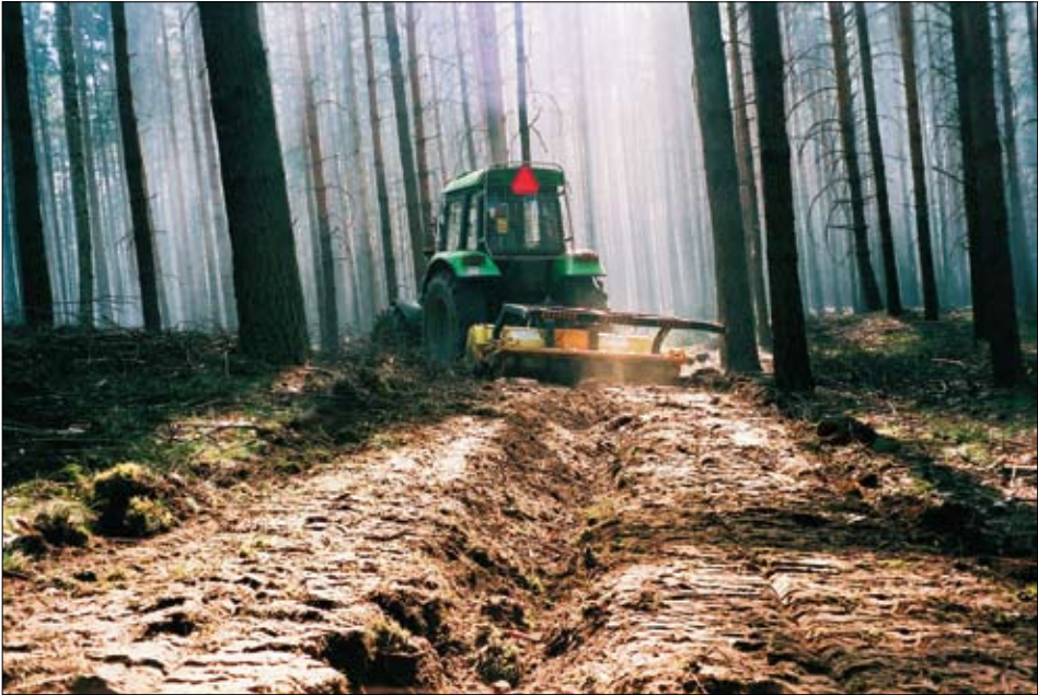
Mechaniczne dogaszanie na obwodzie pożaru
