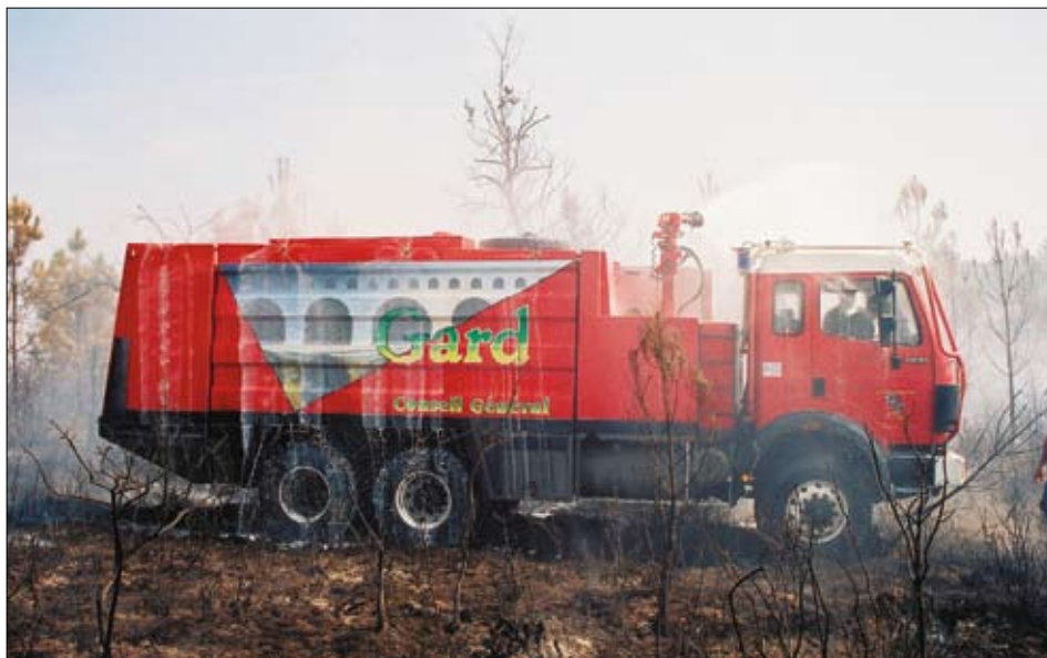
Ciężki samochód gaśniczy wodno-pianowy Mercedes (6×6) z systemem tryskaczowej samoobrony nadwozia (Francja)
