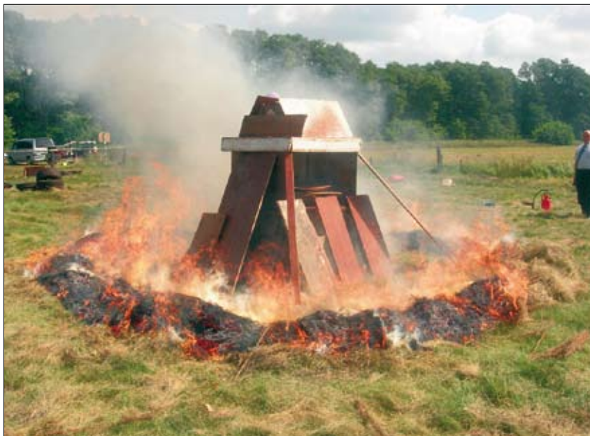
Materiały drewnopochodne pokryte retardantem poddawane „próbie ognia”
