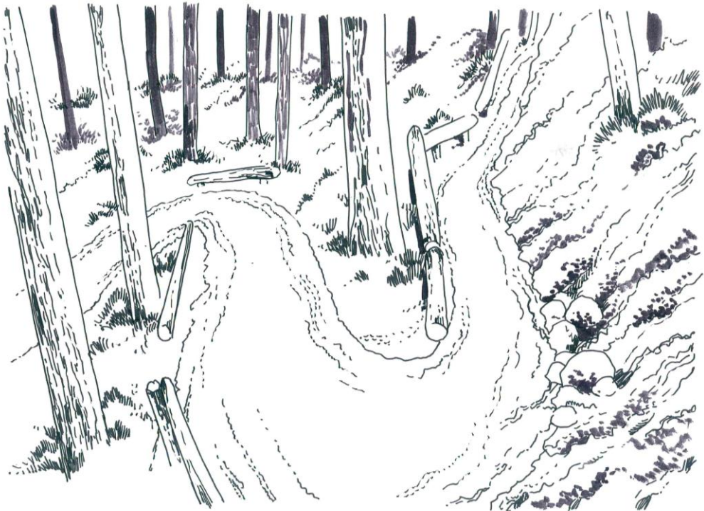
Rysunek 9. Przykład zabezpieczenia krawędzi szlaku przed tworzeniem skrótów (1)
