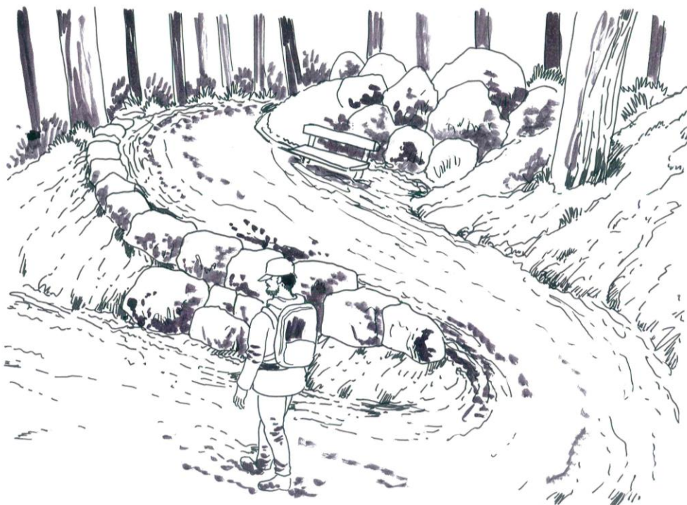
Rysunek 21. Przykład zabezpieczenia krawędzi szlaku prowadzącego serpentynowo (1)
