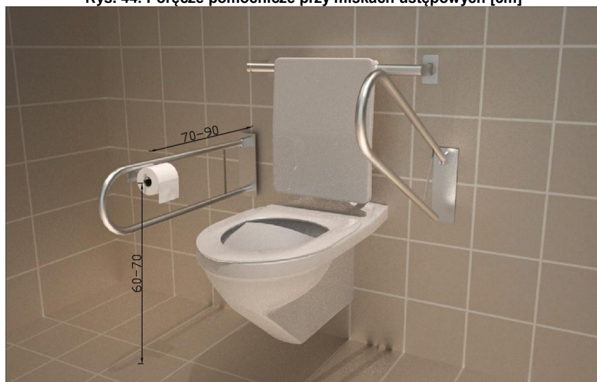
Rys. 44. Poręcze pomocnicze przy miskach ustępowych [cm]
