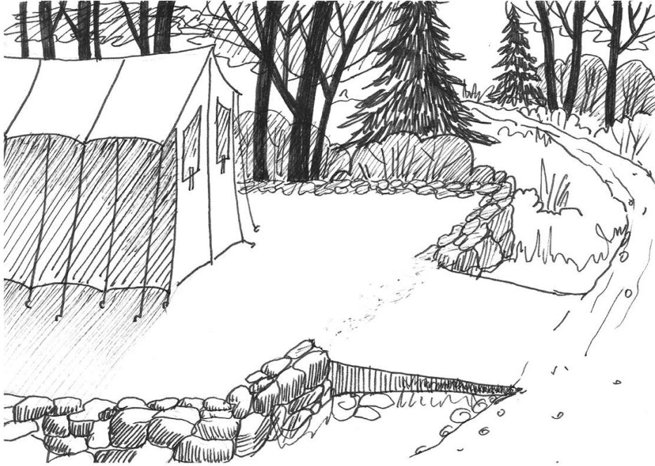
Rys. 51. Przykładowa murowana platforma w obrębie jednego stanowiska biwakowania
