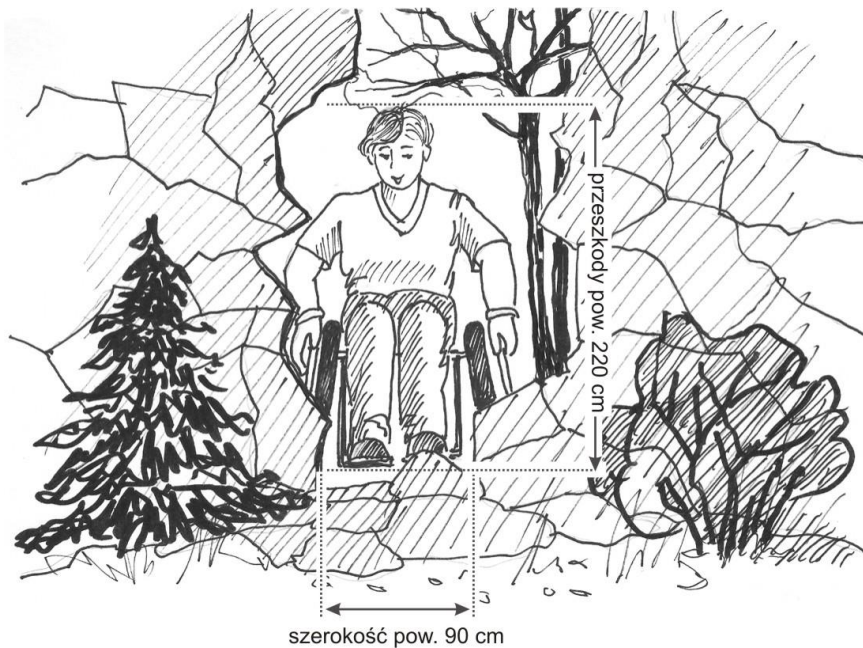
Rys. 13. Przeszkody wystające i zwisające nad trasą
