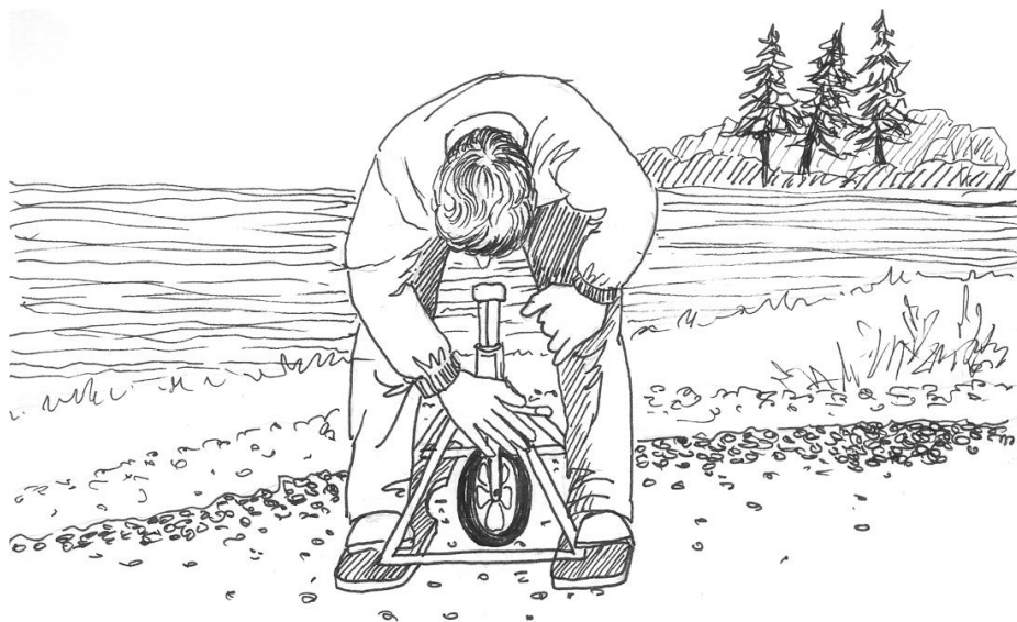
Rys. 10. Zwięzłościomierz (pentrometr) obrotowy
