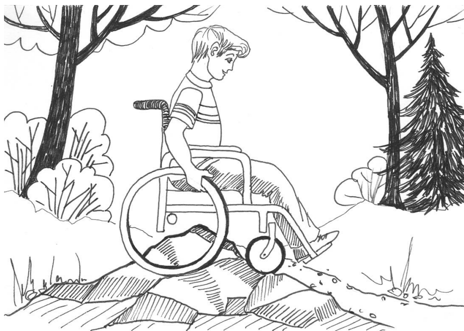
Rys. 6. Niepoprawne rozwiązanie – naglej zmiana nachylenia podłużnego trasy i niebezpieczeństwo utraty stabilności wózka inwalidzkiego
