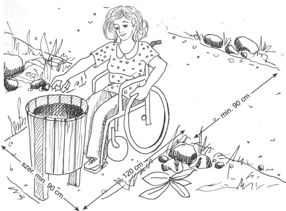
Rys. 36. Parametry techniczne strefy manewrowej wokół kosza na śmieci
