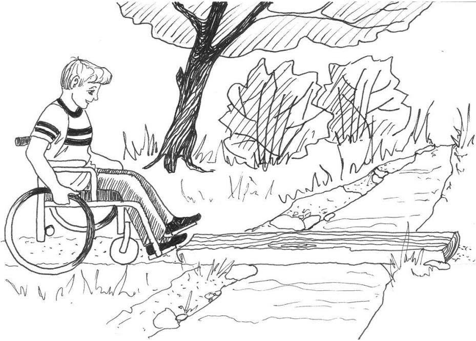
Rys. 15. Bariera dla osoby niepełnosprawnej – zbyt wąska kładka wystająca ponad poziom gruntu
