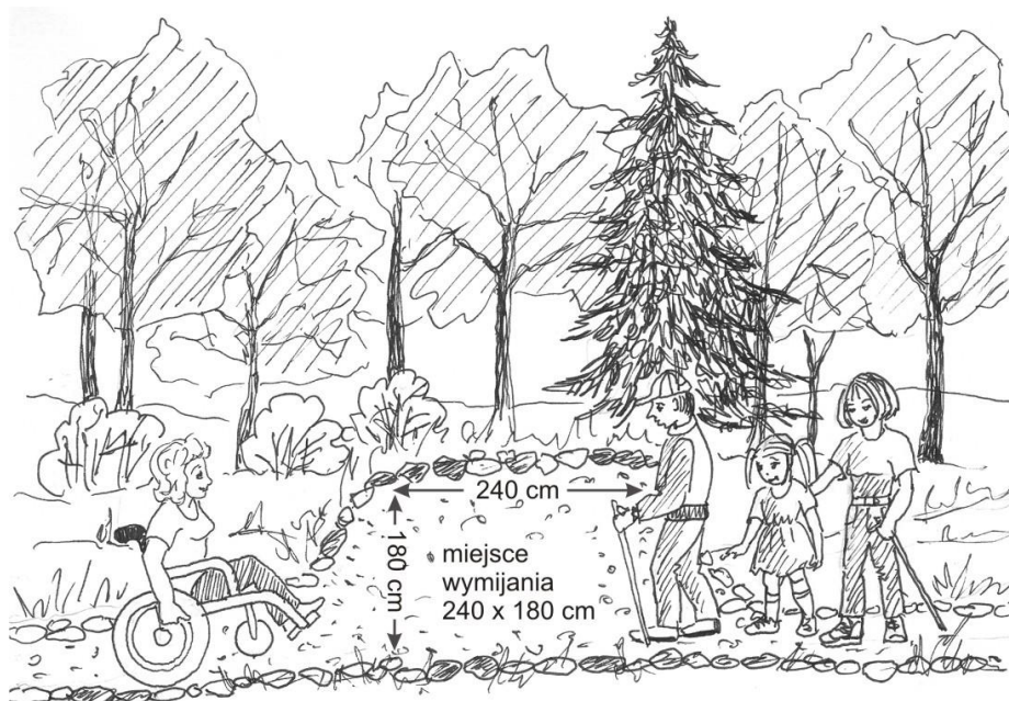
Rys. 12. Miejsca wymijania na trasach węższych niż 150 cm
